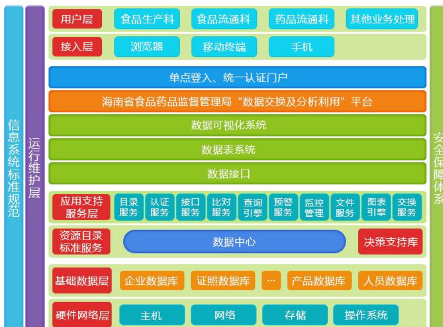
图 1 数据交换及分析利用平台系统架构图
